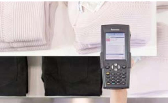
Form einer Antenne. Häufig gibt es noch eine Schnittstelle zu einem Computer, um die empfangenen Daten weiterzuverarbeiten. Die Bauform wird meistens von der Größe der Antenne bestimmt. Es gibt stationäre und mobile Lesegeräte. Die **Reichweite** der Geräte reicht bei passiven Transpondern von wenigen Zentimetern bis zu vier Meter, was jeweils von der Leistung und der verwendeten Frequenz abhängt. Aktive Transponder können über deutlich größere Distanzen gelesen werden.
