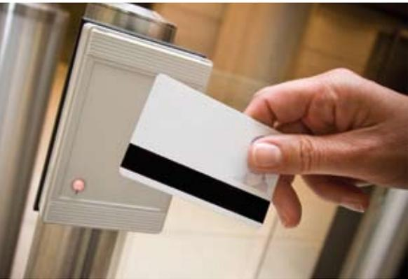
Bei der **Zeiterfassung** werden Chipkarte oder Schlüsselanhänger der Mitarbeiterin oder des Mitarbeiters mit einem RFID-Tag ausgestattet. Auf diesem ist eine Nummer gespeichert, die beim Auslesen durch Verknüpfen mit der Datenbank einer Benutzerin
